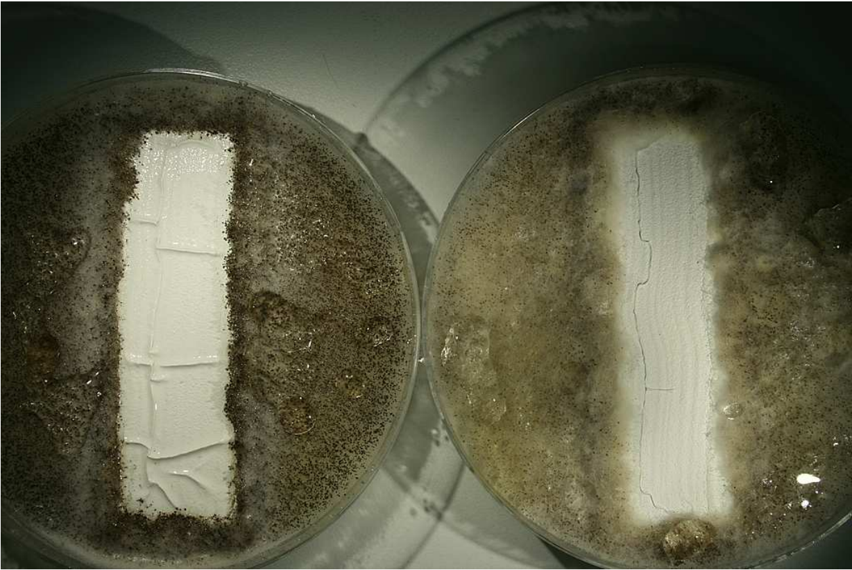
Abb. 1: Ansicht der Proben „Schimmel-Protect“ nach 21 Tagen Versuchsdauer
