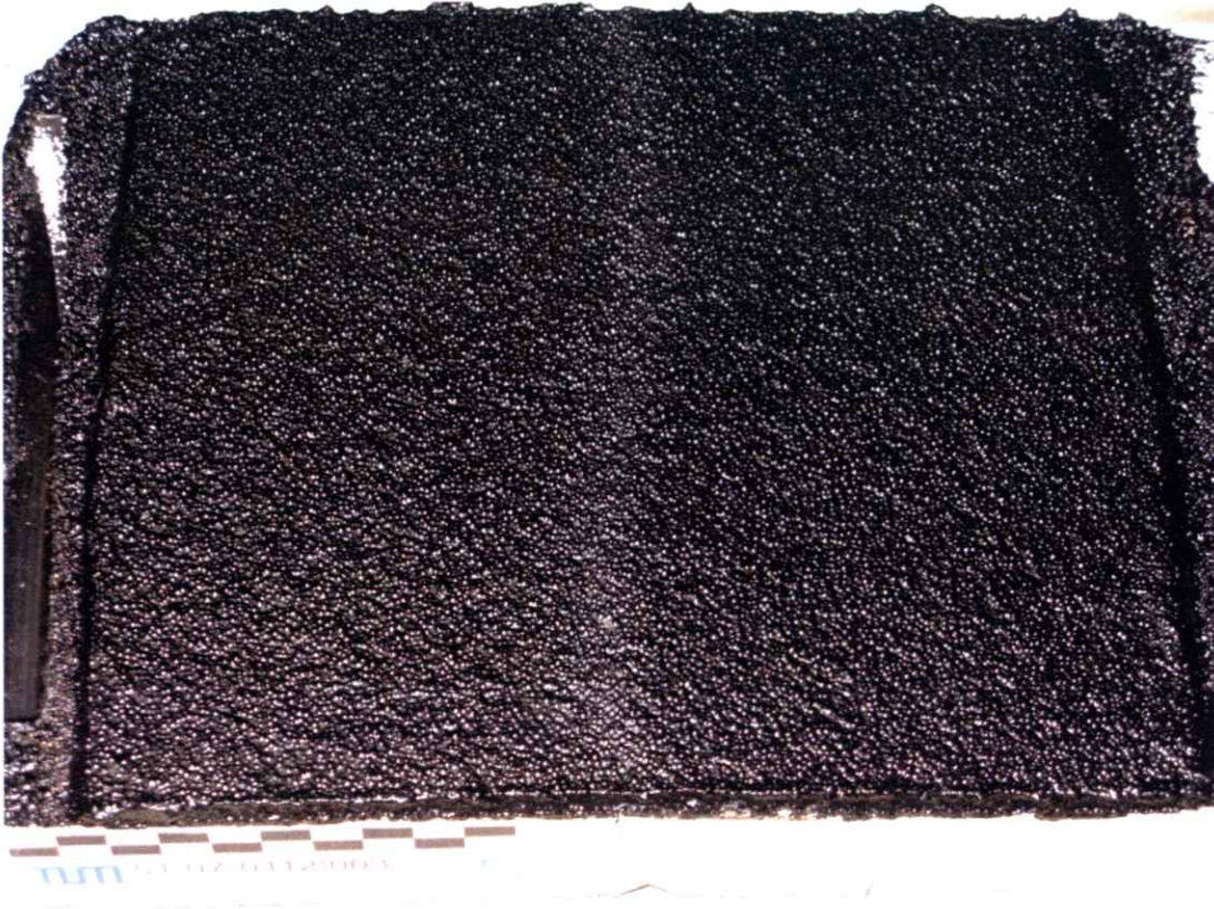
Bild 1: Rissüberbrückung (nach dem Versuch)
